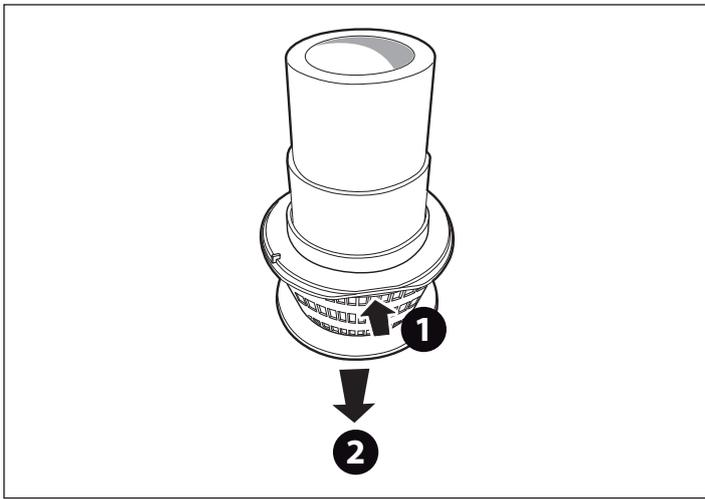
► Cuando esté previsto y resulte necesario desmontar el cesto, presione en la zona indicada para desenganchar el recipiente; luego extráigalo tirando de él hacia abajo.
