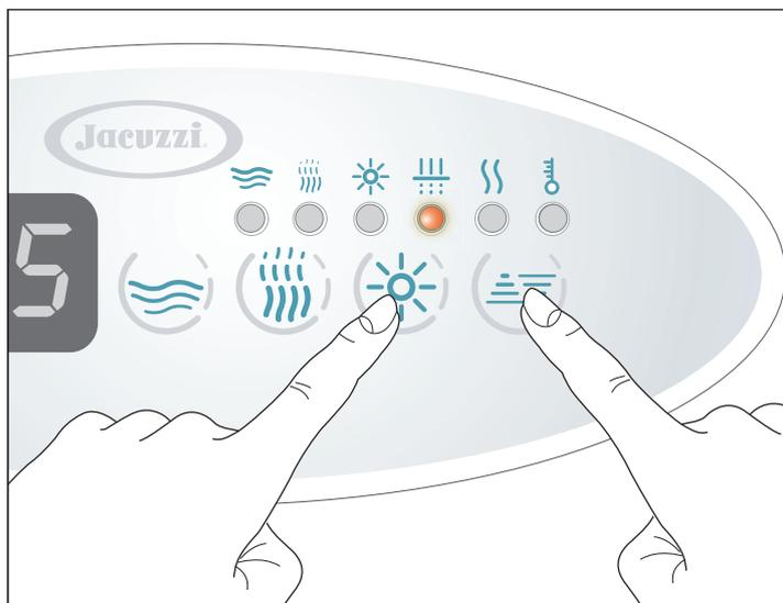
► Die Taste "Light" ☀️ für 5 Sekunden gedrückt halten: auf dem Display erscheint die Schrift **dx** (wobei "x" die Dauer in Stunden anzeigt).
