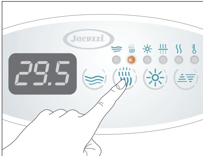
► Pulse el botón **"Blower"** (🌬️) para accionar el compresor de aire (se enciende el led correspondiente).
