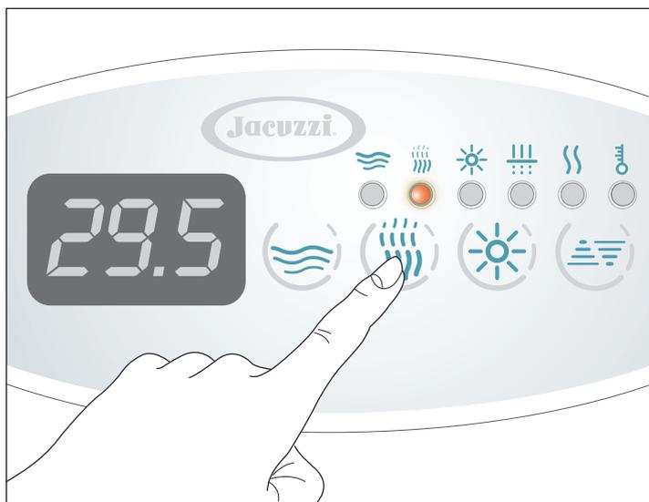
► Appuyer sur la touche "Blower" (☀️) pour actionner le compresseur d'air (la led correspondante s'allume).
