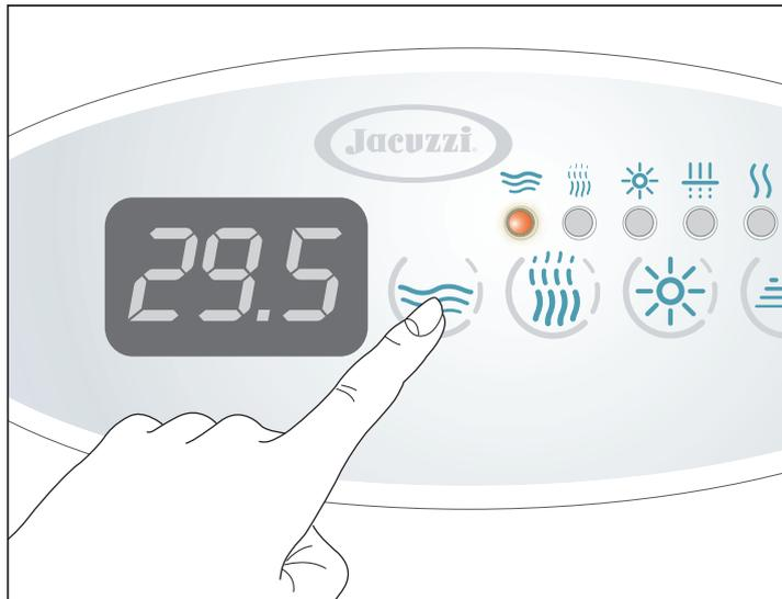
► Нажать один раз клавишу “Pump”
