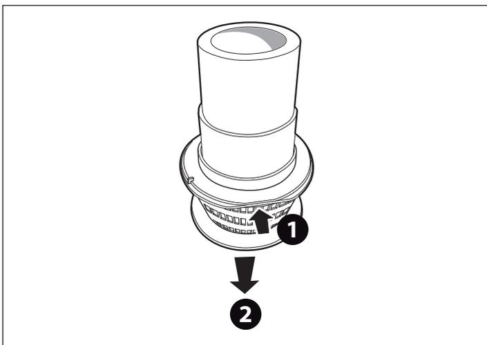
► Если предусмотрено, в случае необходимости, снять корзину, нажать на указанную зону таким образом, чтобы отцепить контейнер; затем отсоединить, натягивая вниз.
