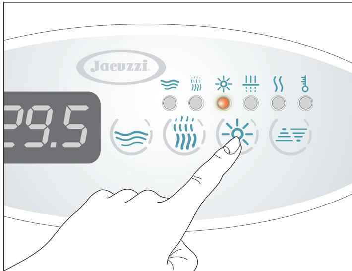
► Zum Einschalten des Strahlers die Taste "Light" ☀️ an der Beckenwand drücken (die entsprechende Led schaltet sich ein).
