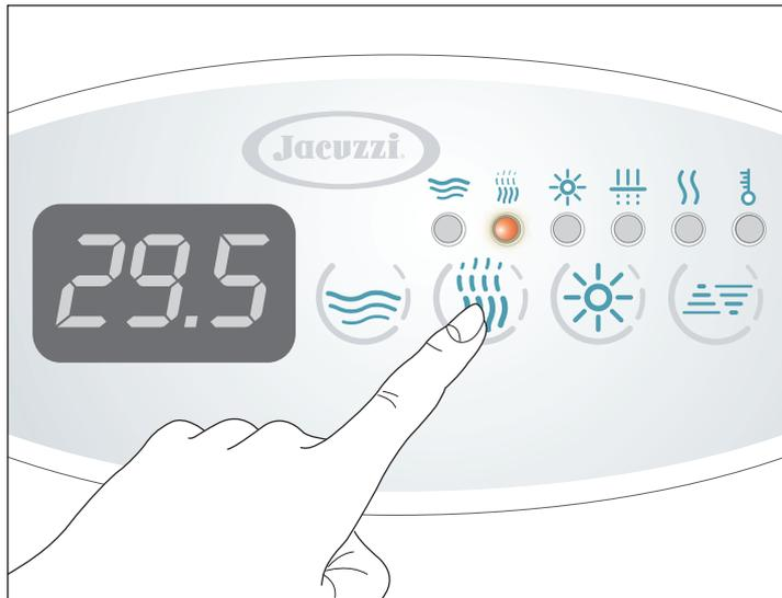
► Нажать клавишу “Blower” (🌀) для подключения компрессора воздуха (включается соответствующий светодиод).
