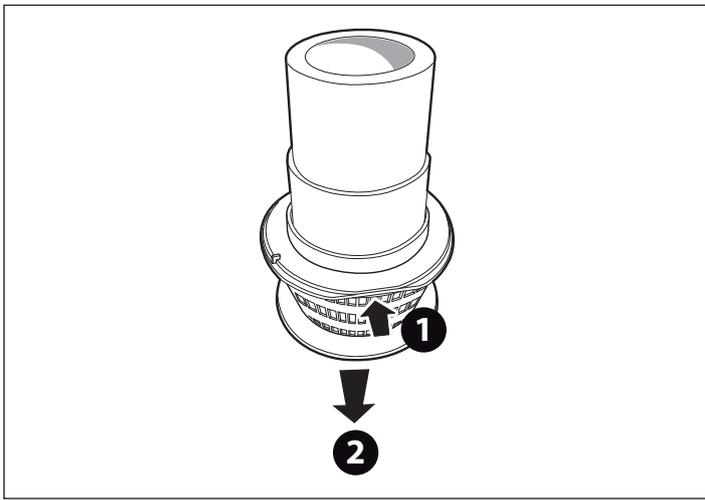
► Si prévu et s'il devient nécessaire de démonter le panier, appuyer sur la zone indiquée de manière à décrocher la boîte ; puis la détacher en la tirant vers le bas.
