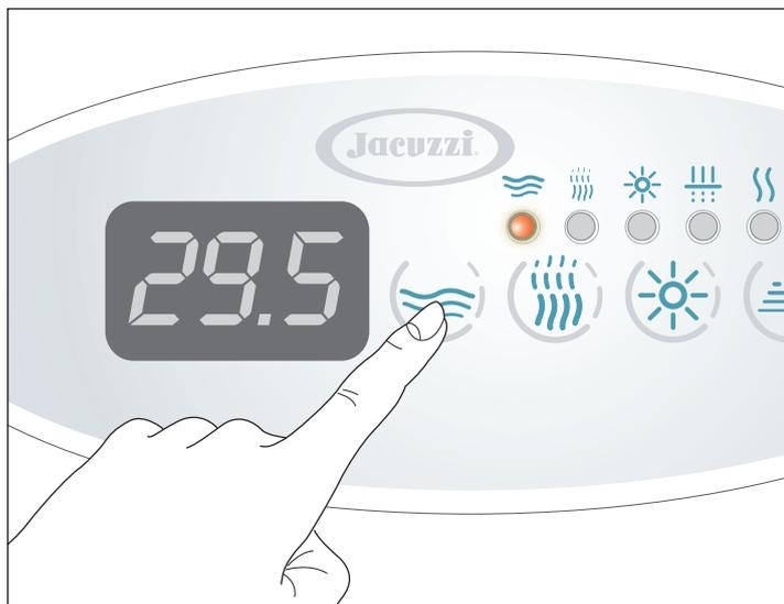
► Premete una volta il tasto "Pump"
